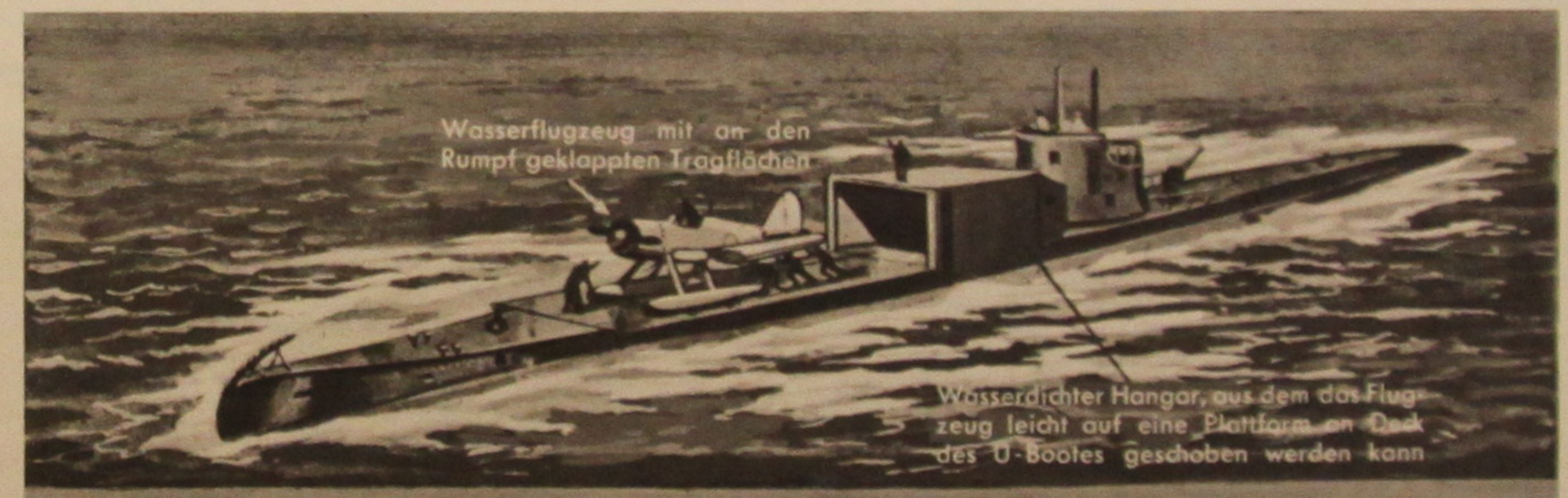
Das U-Boot ist so weit getaucht, daß das Flugzeug frei von der Plattform gekommen ist
